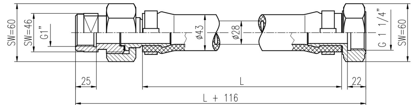
Prüfung und Abnahme: Auf Dichtheit mit 8 bar Prüfdruck.
